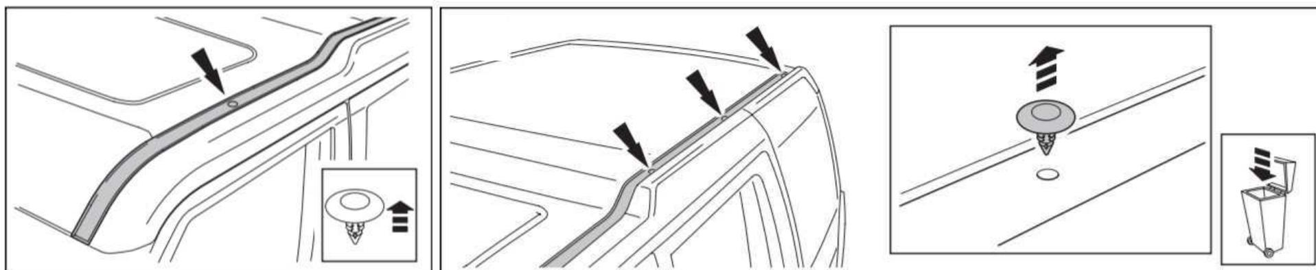
15. Appoggiare delicatamente il portapacchi sul tetto del veicolo, facendo combaciare i fori delle staffe **D** e **E** alle predisposizioni di fissaggio presenti sul tetto
