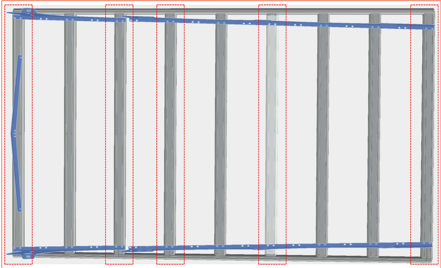
12. Inserire 2 viti M6x14 in ciascuna cava delle traversa anteriore **A1** e con i dadi autobloccanti fissare il deflettore anteriore **F**
