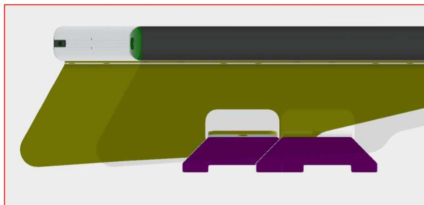
15. Posizionare ora il portapacchi sul distanziatore dell'attacco da tetto e avvitarlo utilizzando i dadi autobloccanti M8
