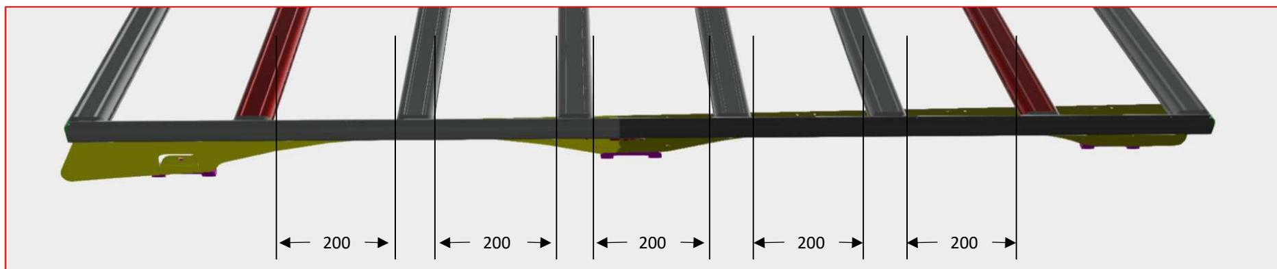
7. Prendere la traversa **A1** e **A2** (prima e ultima traversa del piano di carico) e unirla alle barre laterali **C**
