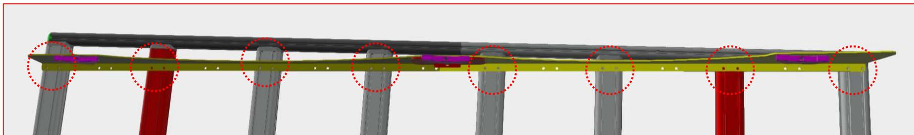
12. Inserire 2 bulloni M6 all'interno di ciascuna fessura della traversa **A1**, utilizzare i dadi autobloccanti M6 in dotazione per il montaggio del deflettore anteriore **F**
