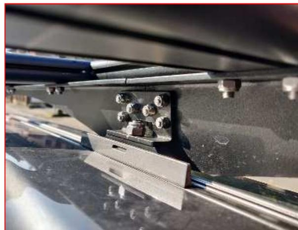
11. Inserire 2 bulloni M6 all'interno di ciascuna fessura della traversa contrassegnata e, utilizzando i dadi di bloccaggio di arresto M6 in dotazione, montare le staffe al tetto di carico senza serrarlo completamente
