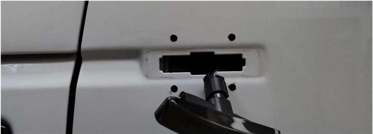
Usando la rivettatrice inserire i 4 inserti filettati:
