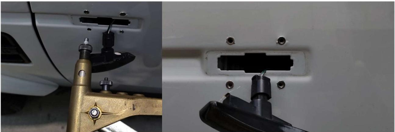
Reinserire la freccia in posizione e usando la chiave a brugola avvitare la griglia di protezione:
