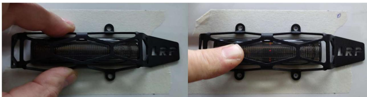
Usando il bulino, segnare ulteriormente i 4 punti così da agevolare il successivo lavoro della punta del trapano. Spostare la freccia verso destra e tirarla verso di se per toglierla dalla portiera:
