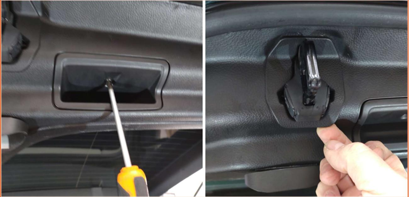
A questo punto il rivestimento inferiore è tenuto in posizione solo da delle clip di plastica, afferrarlo con le mani e tirarlo verso di sé per rimuoverlo completamente:
